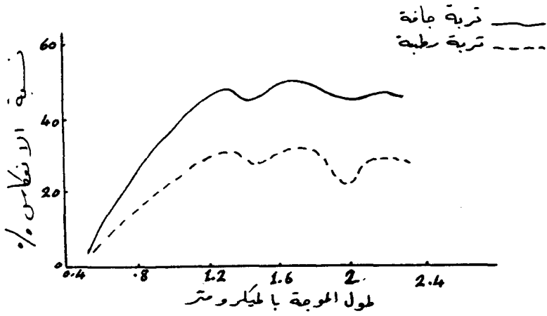
شكل رقم / ٤ / العلاقة بين رطوبة التربة ونسبة الانعكاس
